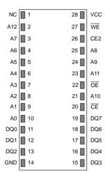
28-PIN ENCAPSULATED PACKAGE (700 MIL EXTENDED)
