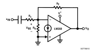
$$\begin{split} A_{V(AC)} &= -\frac{R_f}{R_s} \\ V_{o(DC)} &= V_{BE}(-) \left(1 + \frac{R_f}{R_B}\right) + I_b(-)R_f \end{split}$$
