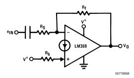
$$\begin{split} A_{V(AC)} &= -\frac{R_f}{R_s} \\ V_{o(DC)} &= V_{BE}(-) + R_f \left[ \frac{V^+ - V_{BE}(+)}{R_b} + I_b(-) \right] \end{split}$$
