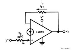
$$\begin{split} &V_{o(DC)} = V_{BE}(-) + I_{FB} \; R_f \\ &I_{FB} = I_{IN}(+) \; A_I + I_b(-) \\ &I_{IN}(+) = \frac{V^+ - V_{BE}(+)}{R_b} \end{split}$$
