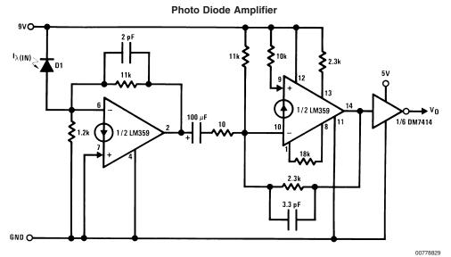
D1 ~ RCA N-Type Silicon P-I-N Photodiode
