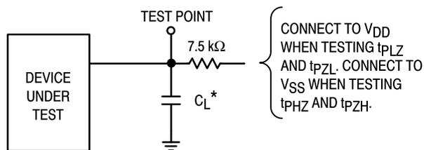
CONNECT TO V<sub>DD</sub> WHEN TESTING t<sub>pLZ</sub> AND t<sub>pZL</sub>. CONNECT TO V<sub>SS</sub> WHEN TESTING t<sub>pHZ</sub> AND t<sub>pZH</sub>.
