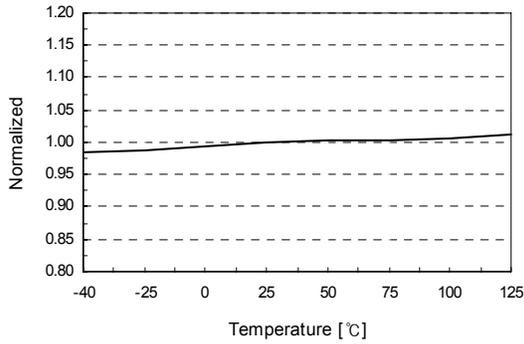
Figure 6. Start Threshold Voltage ( $V_{\text{START}}$ ) vs.  $T_A$
