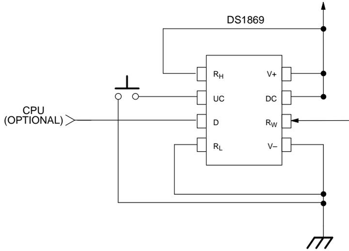
**DS1869 DUAL PUSH-BUTTON CONFIGURATION (TYPICAL EXAMPLE) Figure 2A**
