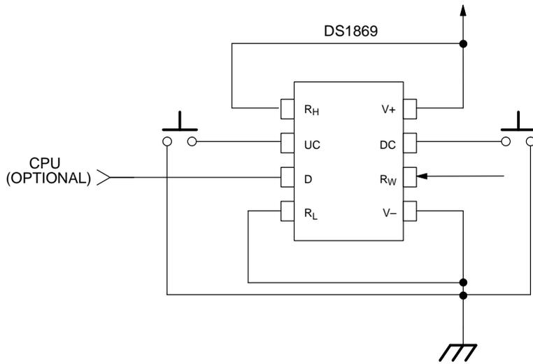
**DS1869 DUAL PORT CONFIGURATION (TYPICAL EXAMPLE) Figure 2B**
