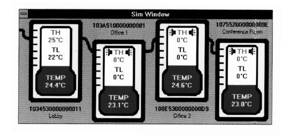
The DS1820K demonstration kit allows a potential user of the DS1820 to observe the operation of the DS1820 in an actual, multipoint temperature measurement application.
