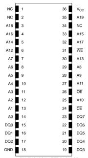
36-PIN ENCAPSULATED PACKAGE 740 MIL EXTENDED
