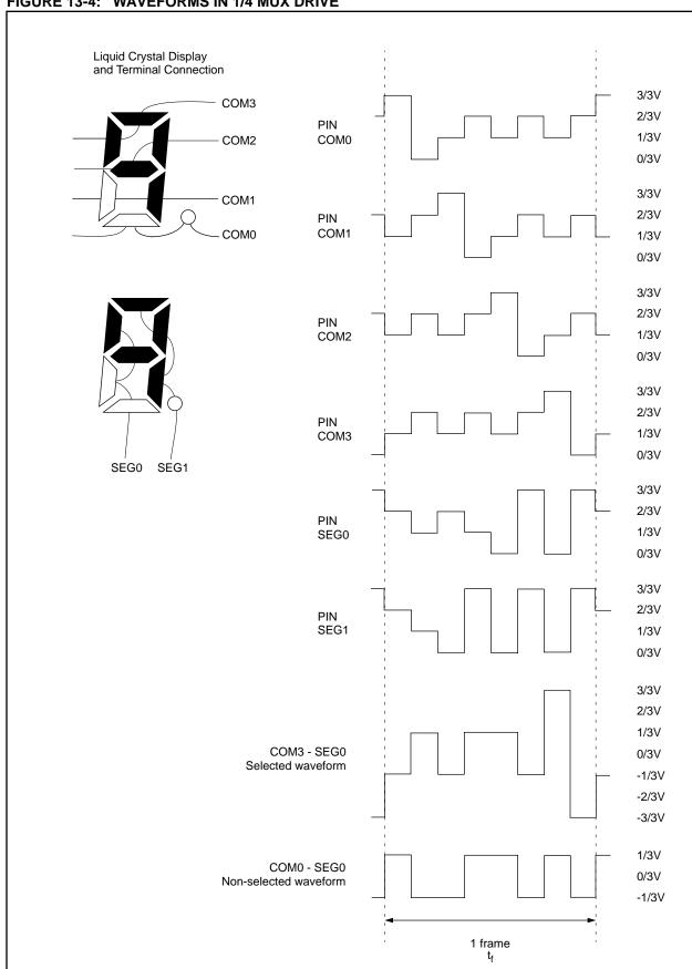
FIGURE 13-4: WAVEFORMS IN 1/4 MUX DRIVE
