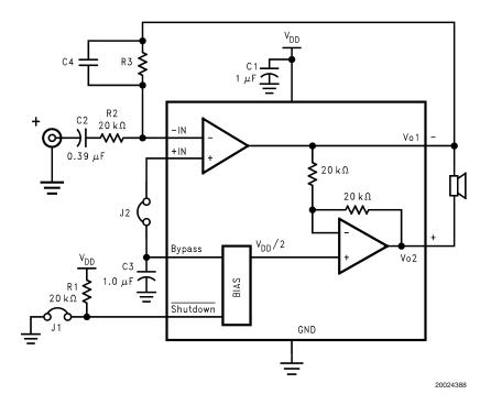
FIGURE 2. HIGHER GAIN AUDIO AMPLIFIER
