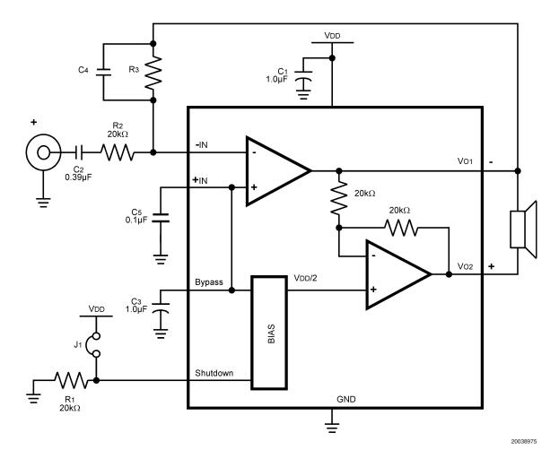
FIGURE 2. HIGHER GAIN AUDIO AMPLIFIER
