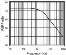
Figure 18. PSRR V<sub>S</sub>=5V
